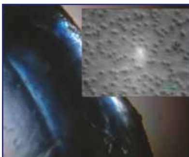
Mikroskopický snímek povrchu polymerního chemicko-optického převodníku OVS plynného čpavku. Modré zabarvení je způsobeno přítomností organo-metalického reagentu. Ve výřezu je mikrostruktura vnějšího sekundárního obalu s viditelnými mikropóry zvyšujícími difúzi cílového plynu.
